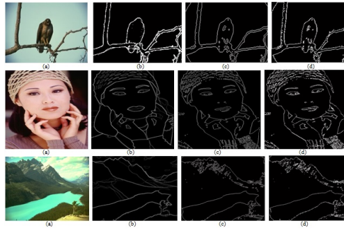
Figure 1. Résultats visuels de QGA et comparaison (a) Image Originale (b) Vérité terrain (c) Contour de Canny (d) Contour de QGA
